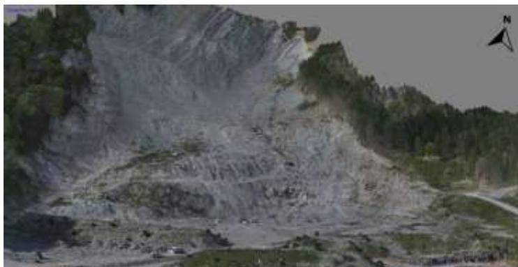
Fig. 17 Modello tridimensionale del versante derivato dal rilievo fotogrammetrico da piattaforma SAPR. Vista Sud-Nord.
