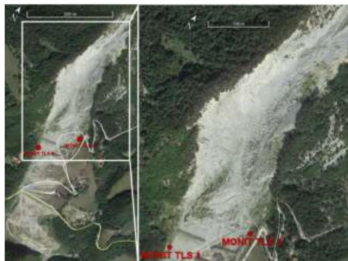
Fig. 5 Ubicazione, su immagine ottica satellitare, delle postazioni di monitoraggio permanenti con tecnica TLS.
