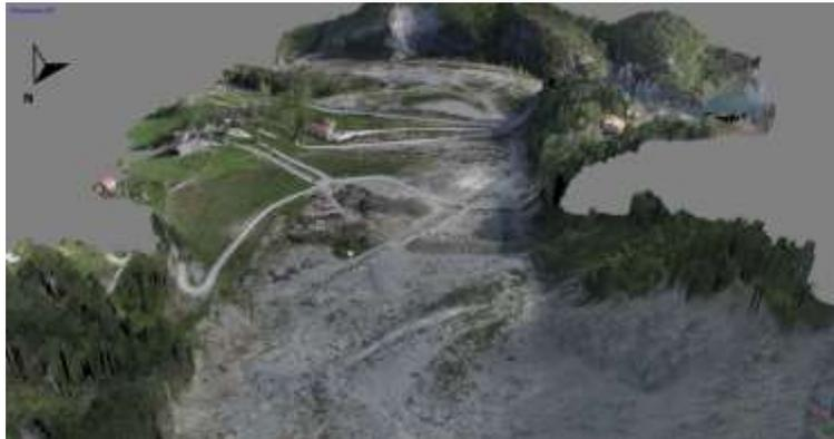
Fig. 18 Modello tridimensionale del versante derivato dal rilievo fotogrammetrico da piattaforma SAPR. Vista Nord-Sud.
