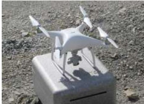
Fig. 16: APR modello DJI Phantom 4 utilizzato per la presa delle immagini aeree.
