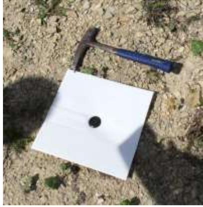
Fig. 14: Uno dei 13 target (GCPs) posizionati all'interno dell'area di rilievo.
