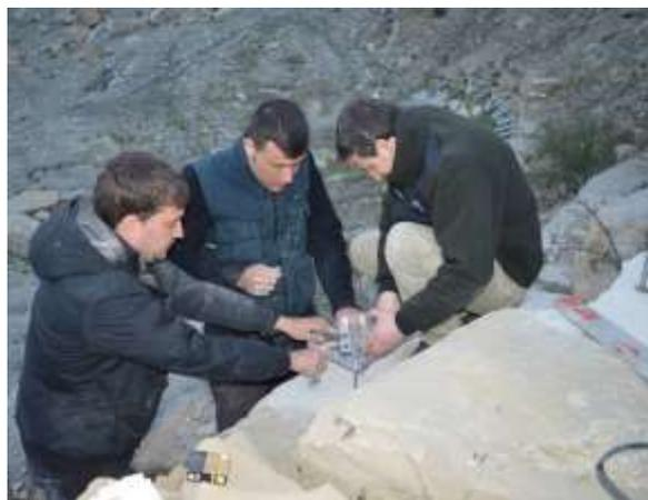
Fig. 8 Installazione della stazione di monitoraggio permanente DIC in sito.
