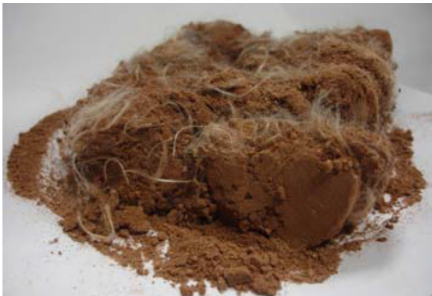
Fibre di polipropilene in sabbia (Lirer et al., 2011)
